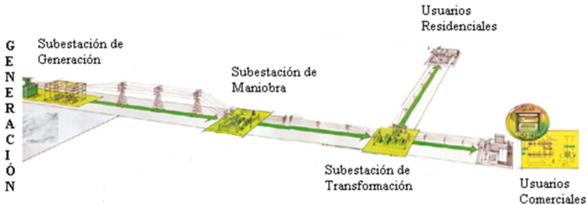
Figura 3.2.- Tipos de subestaciones [24].
