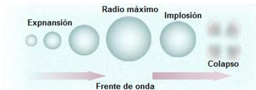
Figura 1: Fenómeno de Cavitación, expansión, implosión y colapso de la burbuja.
