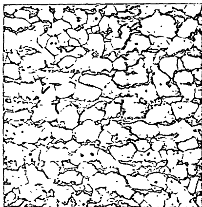
FIG. II-36.—120 X — Estructura de ferrita-perlita del acero suave (C=0,18%).
