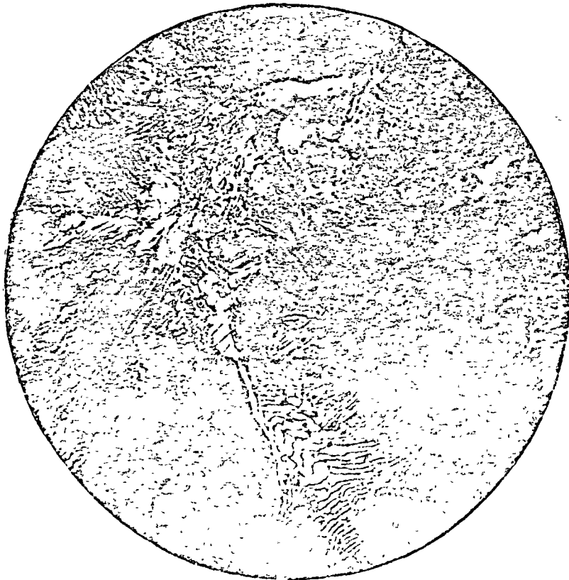
Fig. II-9.—4000 X — Estructura de la sorbita. (Micrografía bajo luz ultravioleta por F. LUCAS.)
