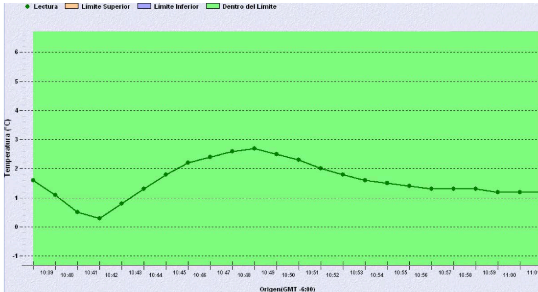
Figura 5.7. El comportamiento del control de temperatura presenta un funcionamiento adecuado, la gráfica presenta un valor máximo de 2.7 °C y un mínimo de 0.3°C
