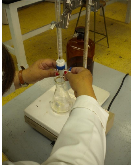
Figura 16.- Titulación de la solución cianurada con nitrato de plata
