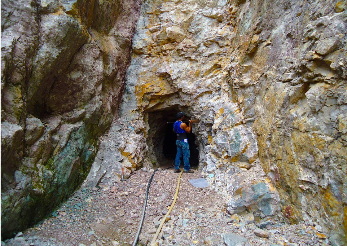
Socavón Pipes-1, principal estructura de la propiedad, donde se observa muy bien la veta con forma V invertida, casi vertical, roca encajonante riolítica color marrón, planos de falla, así como la alteración propilítica
