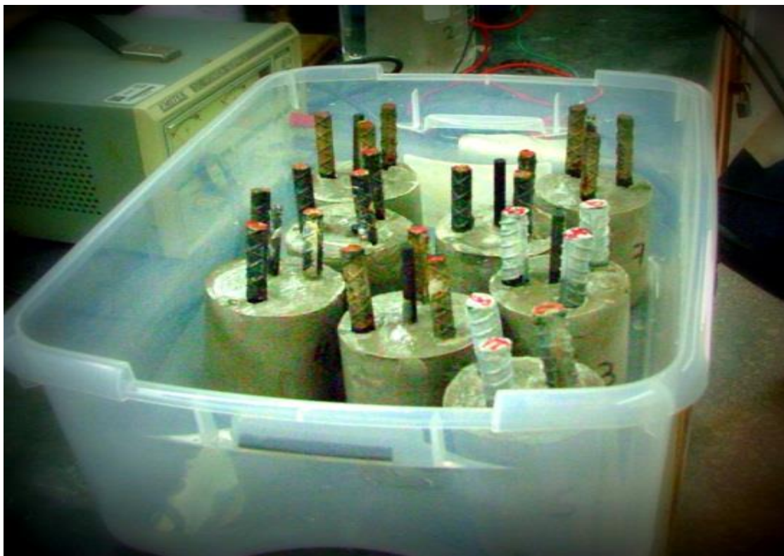
Figura (2.5.1.4): Probetas finales de acero de refuerzo embebidas en pasta de cemento.
