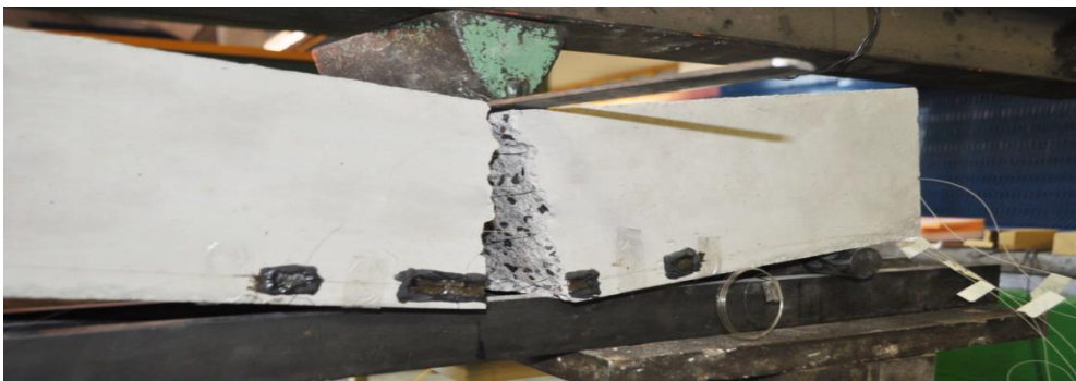
Figura 63. Fractura de la viga y del sensor FBG (fotografía).
