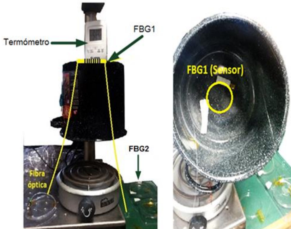
Figura 20. Arreglo utilizado en la caracterización de la respuesta de la FBG a temperatura.
