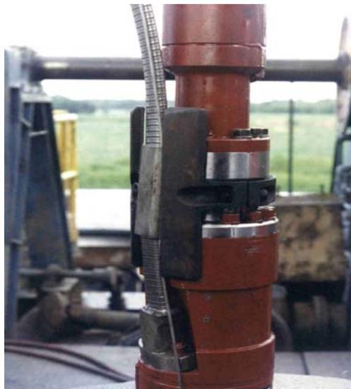
**Figura 1.4.- Conexión Mufa – Motor.**
