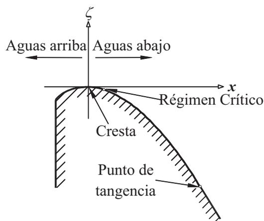
Figura 4.2: Posición del tirante crítico sobre el perfil de un cimacio
