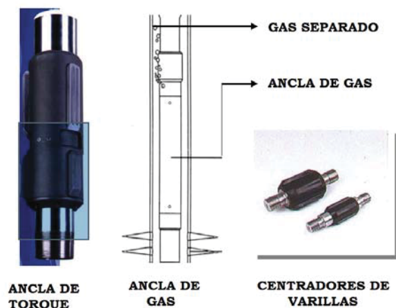
Figura 20. Accesorios sub-superficiales del BCP
