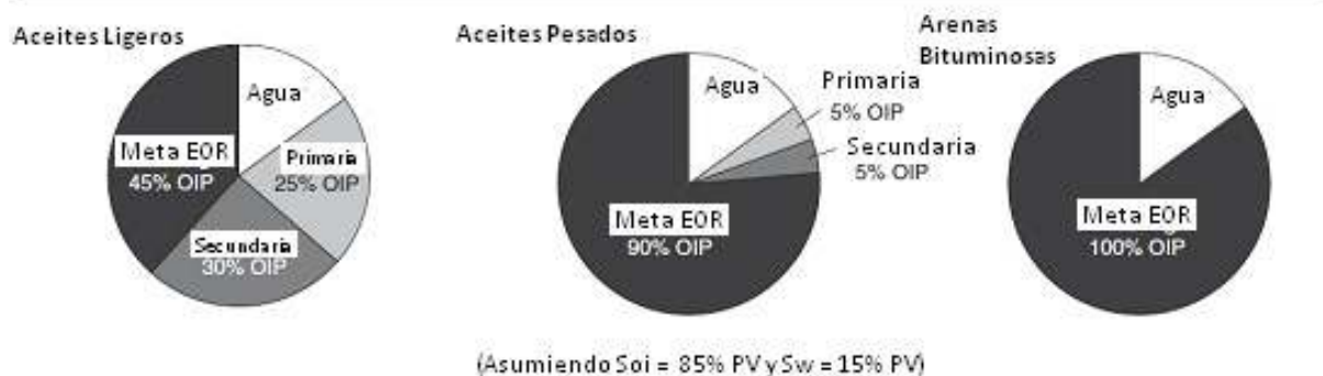
Fig. 2.5. Aceite a recuperar de un yacimiento a través de tecnologías EOR para diferentes tipos de aceite. (S. Thomas, 2007)
