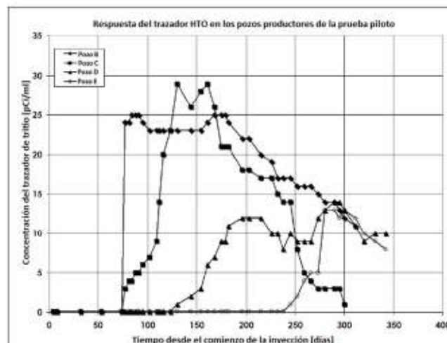
Fig. 5.33. Perfiles de concentración del trazador “agua tritiada” capturados en los cuatro pozos productores. (Noel Tyler, Herón Gachuz Muro, Jesús Rivera-R, Juan Manuel Rodríguez Domínguez, Santiago Rivas-Gómez & Roger Tyler, 2004)
