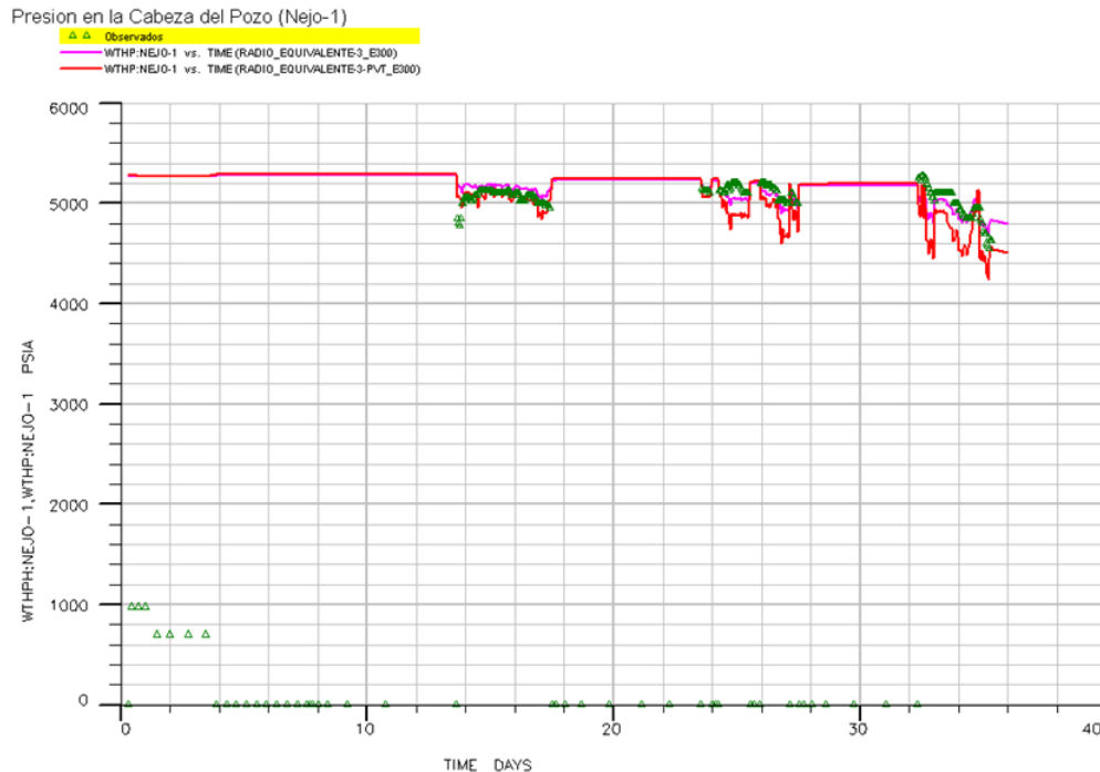
Figura 6.17 Comportamiento de Presión en la Cabeza del Pozo con el Modelo de Radio Equivalente
