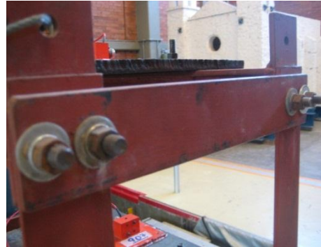
b) Colocación de soleras en el modelo
