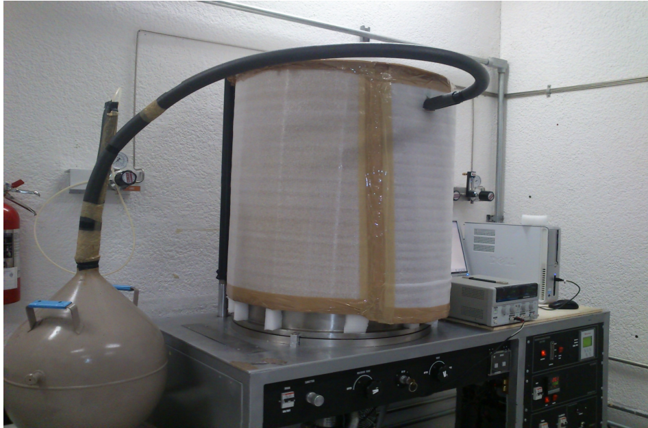
Figura 81: Cámara de vacío conectada al nitrógeno líquido para enfriar
