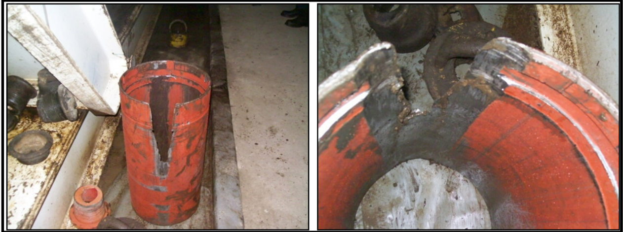
Figura. 6. 2. Bujes de desgaste numero 2 observado en la perforación de 12 ¼”.
