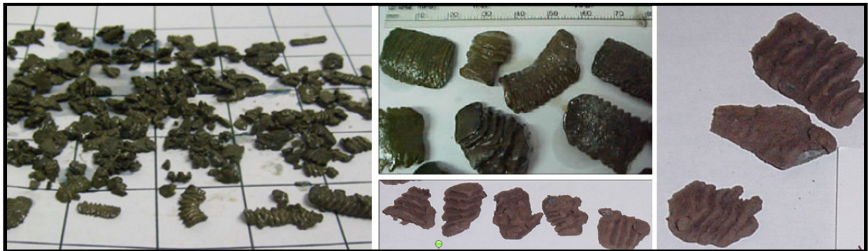
Figura 3.4. Recortes de formación característicos de barrena tipo PDC
