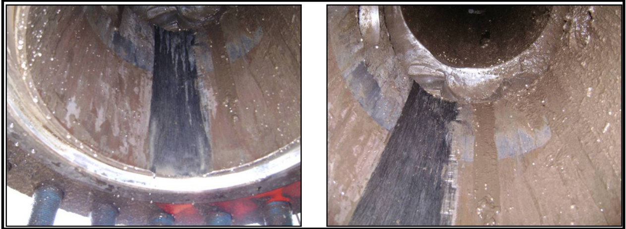
Figura. 6. 4. Daño observado en el interior del preventor de 13 5/8" 10M
