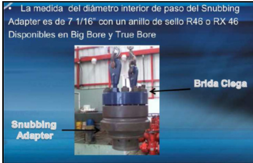
Figura. 6. 8. Snubbing Adapter utilizado en conjunto con el equipo de control de presiones - MPD
