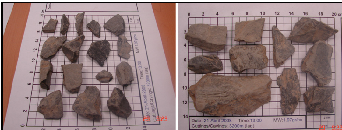
Figura 3.8. Muestras recuperadas de la profundidad de 3200 m del pozo Pache 21.
