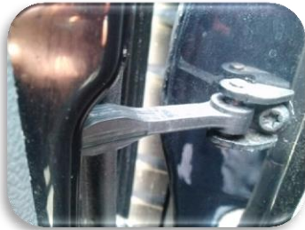
Fig. 6.6 Freno de puerta de Chevy 2007
