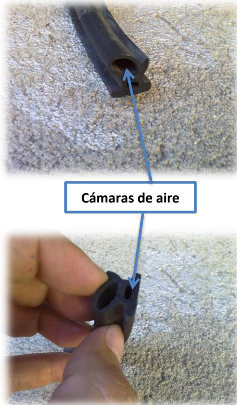
Fig. 6.10 Corte transversal del empaque de neopreno
