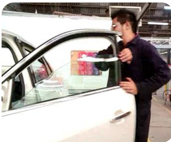
Fig. 5.13 Demostración de una fuerza de empuje durante una prueba de azote.
