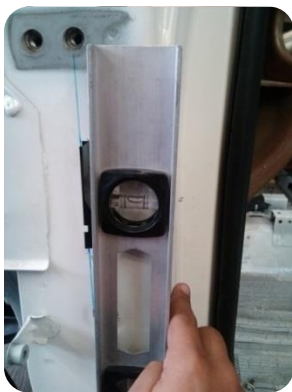
Fig. 6.5 Segundo ángulo de inclinación de la puerta
