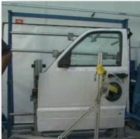
Fig. 5.3 Banco de pruebas para puertas de la compañía MGA
