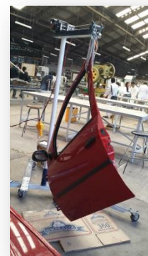
Fig. 7.25 Puerta suspendida con la grúa.
