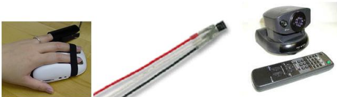
Figura 16. Componentes del sistema para el monitoreo fisiológico no intrusivo para la detección de estrés en la interacción humano - computadora [37].
