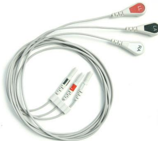
Figura 36. Cables para la conexión de los electrodos con el circuito de acondicionamiento de señal
