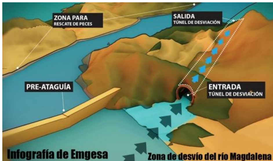
Figura 1.15 Forma en la que se desvía un río, figura sustraída de la página http://www.opanoticias.com/actualidad/asi-sera-el-desvio-del-rio-magdalena-en-el-quimbo_12899
