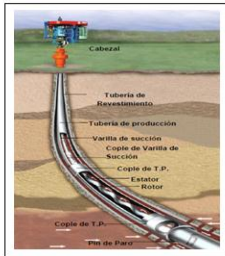
Figura 1.9 Configuración de las principales partes de un BCP 4
