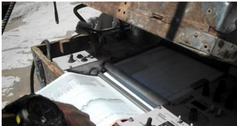
**Fig. 3\_14 Verificación de verticalidad con KODEN. (Gráfica)**
