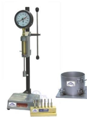
**Fig. 3\_54** Imagen del penetrómetro de laboratorio, el cual se utiliza para determinar el tiempo de fraguado del concreto de acuerdo a la norma NOM-C-166 y ASTM C 403
