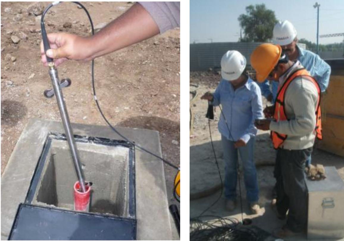
Fig. 4\_5 Toma de lecturas en inclinómetros
