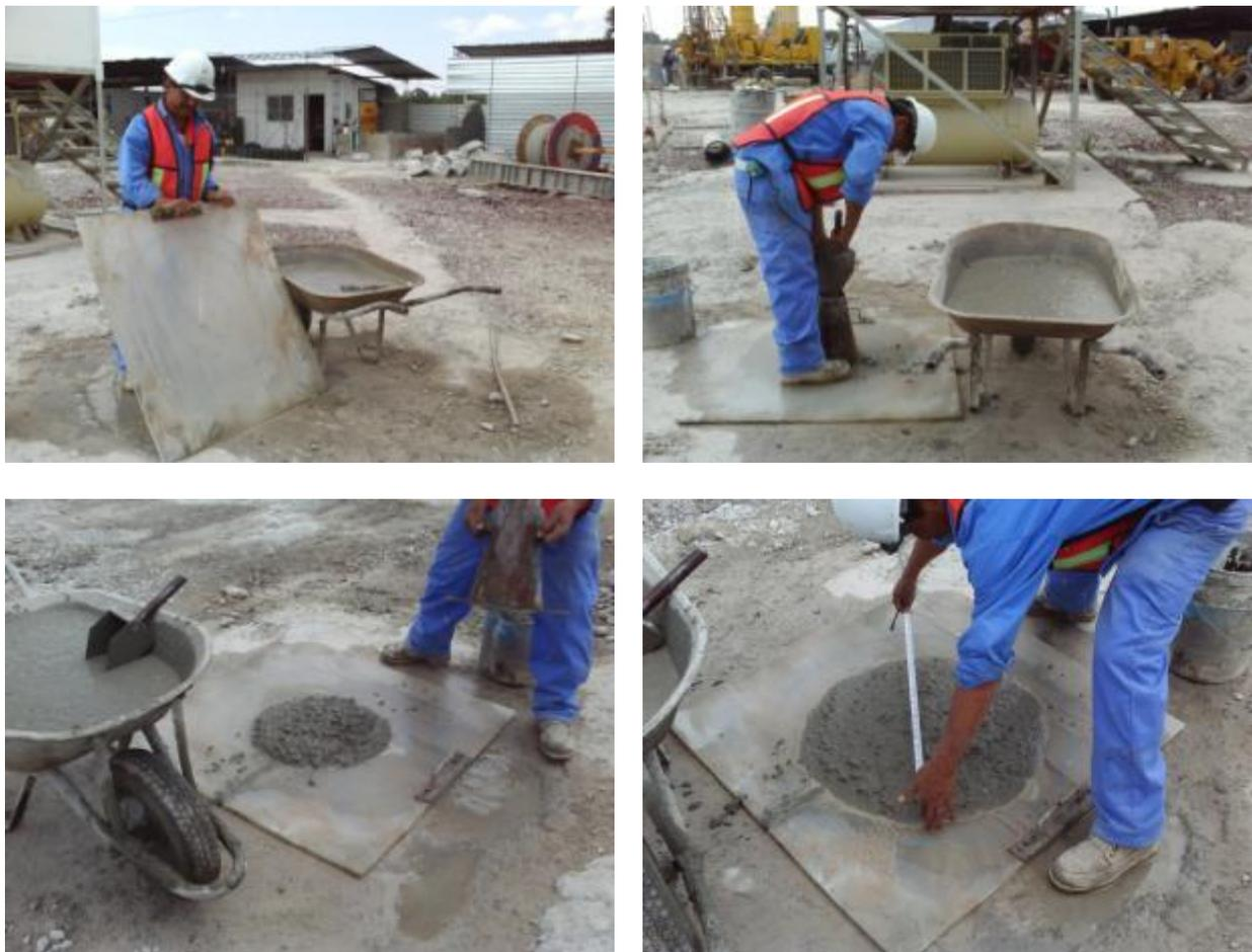
**Fig. 3\_18** Secuencia de prueba de extensibilidad de concreto autocompactable
