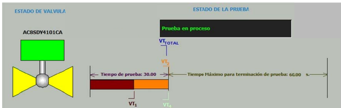
Figura 99. Energizar la solenoide para regresar la SDV a condición inicial.
