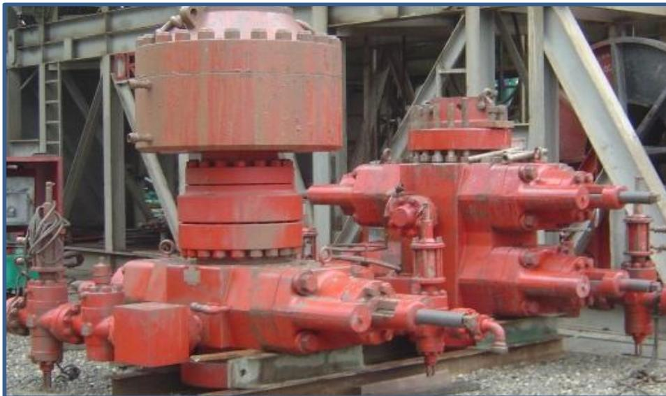
Figura 38. Arreglo de preventores usados en la perforación de pozos geotérmicos.
