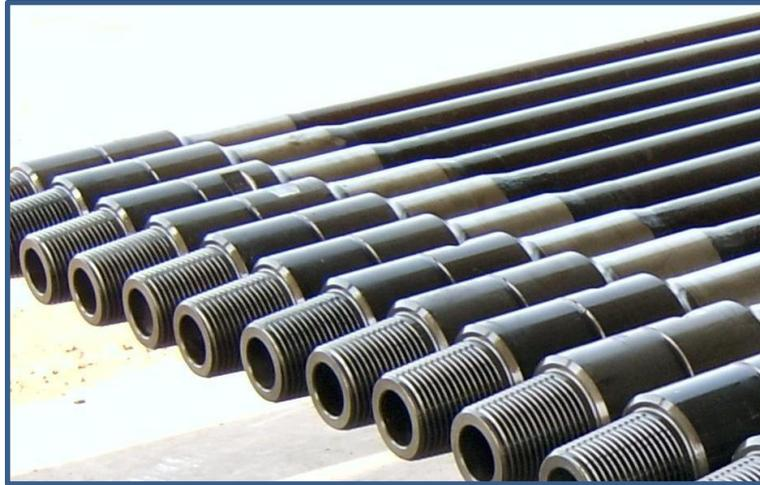
**Figura 46. Tubería pesada.**
