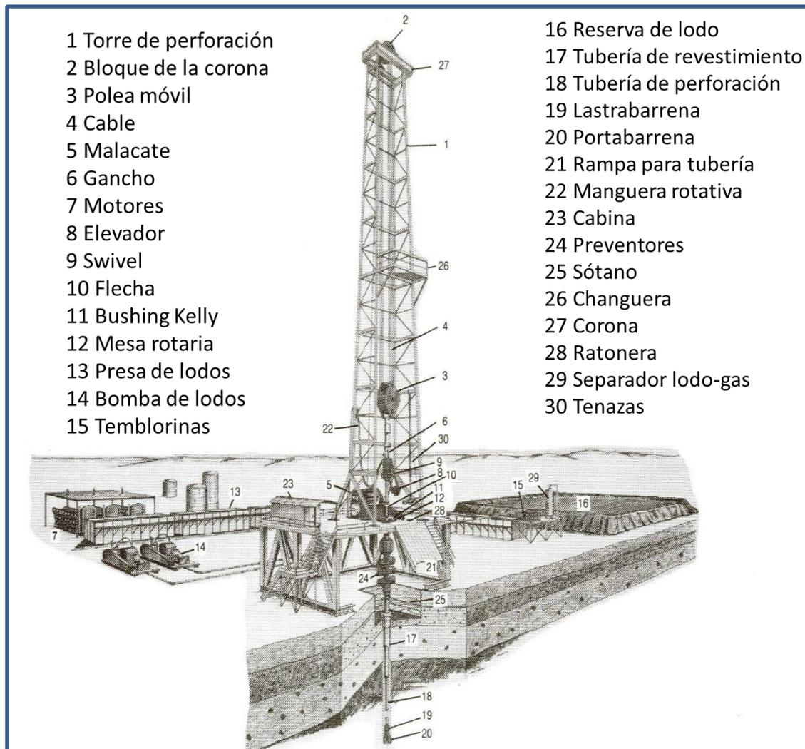
Figura 39. Partes de una plataforma de perforación para pozos geotérmicos.
