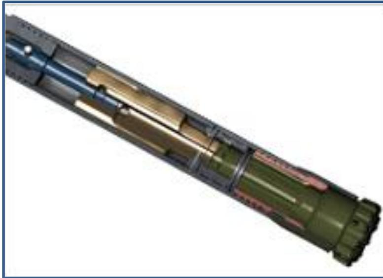
Figura 43. Esquema de martillo para perforación por percusión.
