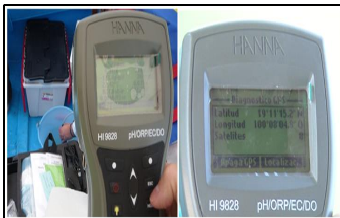
Figura 3.3 Medidor multiparamétrico con GPS HANNA. Fuente: HANNA instruments, 2006.
