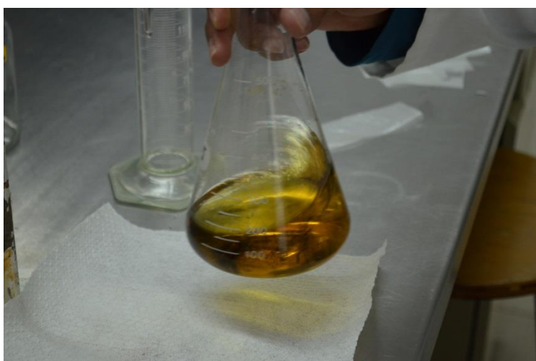
Figura B.3 Titulación de la muestra agregando Tiosulfato de Sodio.
