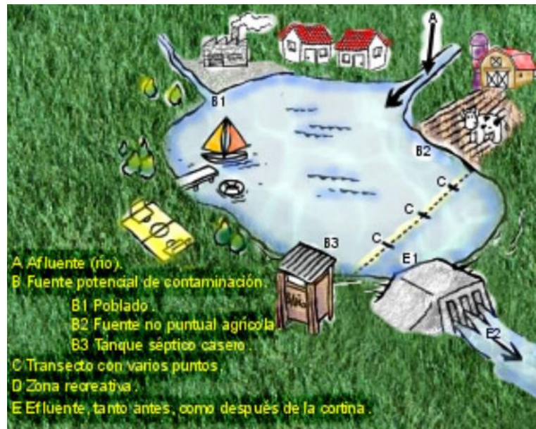
Figura 2.1 Recomendaciones para ubicar las estaciones de muestreo en un lago o embalse. Fuente: Bravo, L., 2004.
