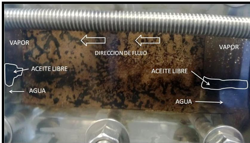
Foto 17. Se observa la roca en la celda al final de la inyección de vapor.
