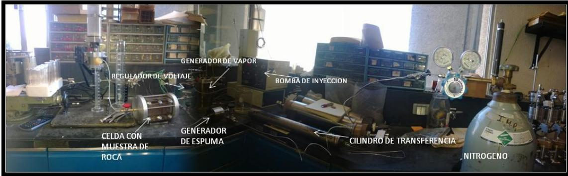
Foto 37. Diseño del tercer experimento.
