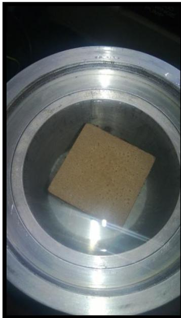
Foto 7. Proceso de saturación de las muestras de roca (núcleos) con agua destilada.
