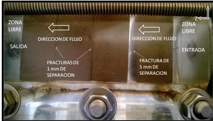
Foto 39. En la imagen se observa la muestra de roca fracturada en la celda antes de empezar la prueba.
