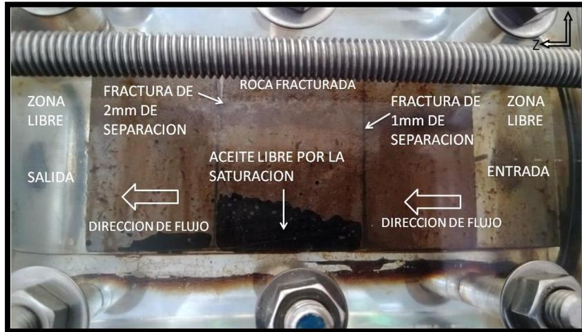
Foto 27. En la imagen se observa la muestra de roca fracturada en la celda antes de empezar a inyectar agua caliente.
