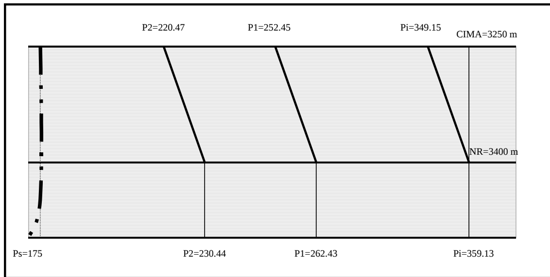
Figura 10.-Determinación de la presión a la cima del yacimiento para cada una de las pendientes
