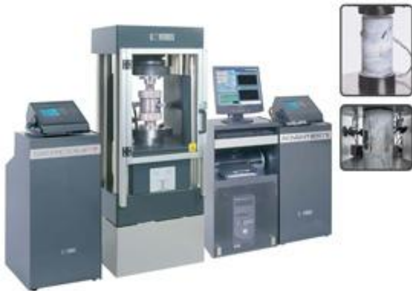
Figura III.5 Prueba Destructiva utilizando una Prensa hidráulica.
