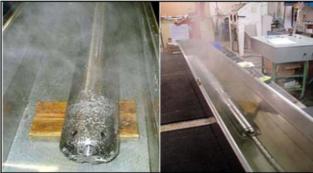
Figura 2.6. Calentador de Tubería con Sistema DHT.
