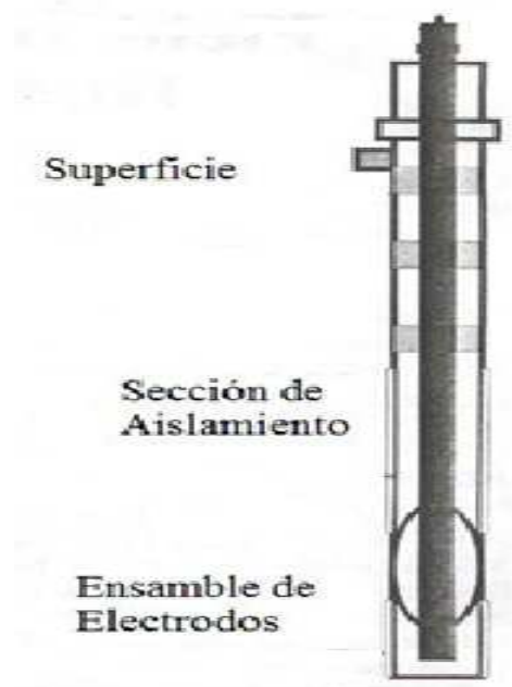
Figura 1-14. Representación del ensamblaje de electrodos en la tubería de producción, (Vermeulen, McGee & Yu, 1999) 17
