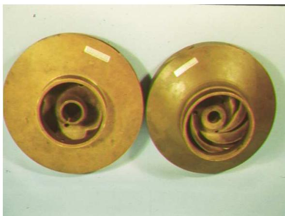
**Figura 5.4 IMPULSOR DE UNA BOMBA CONTRA INCENDIO**
