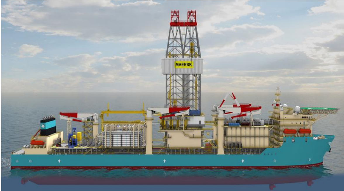
Fig. 2.5.- Barco Perforador de operación dual. Fuente: www.drillingcontractor.org
