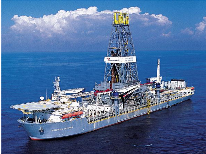
Fig. 1.7.- Fotografía de barco perforador (Drill ship). Fuente: 2b1 ST Consulting, 2012.
