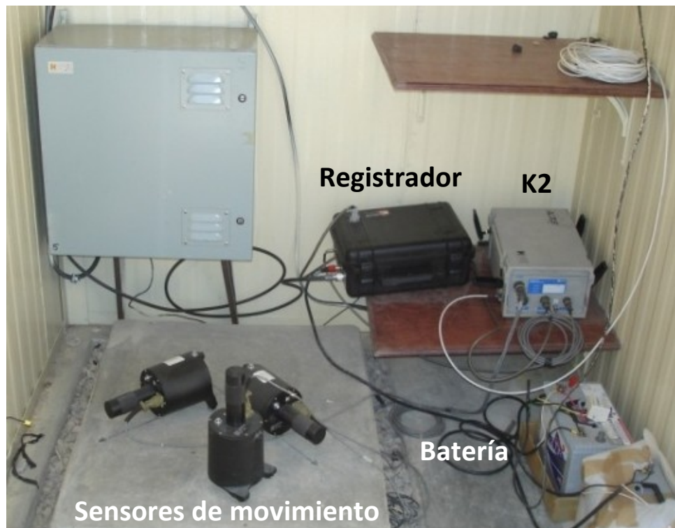
Figura 2.1.3. Elementos que integran una de las estaciones de monitoreo en el campo Los Humeros. Sismómetro de 3 componentes (Z, N-S y E-O): Guralp modelo CMG-6TD.
