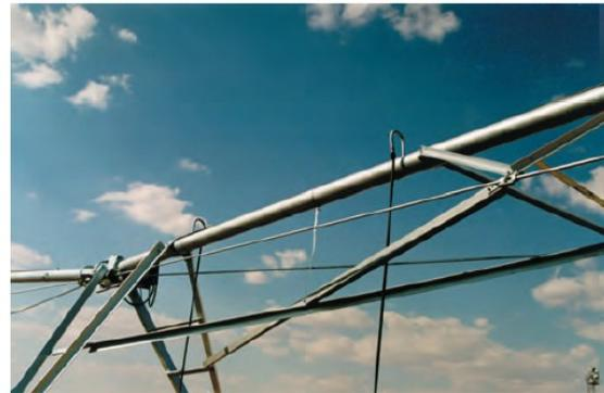
Cada torre está equipada con dos ruedas propulsadas por motores eléctricos
