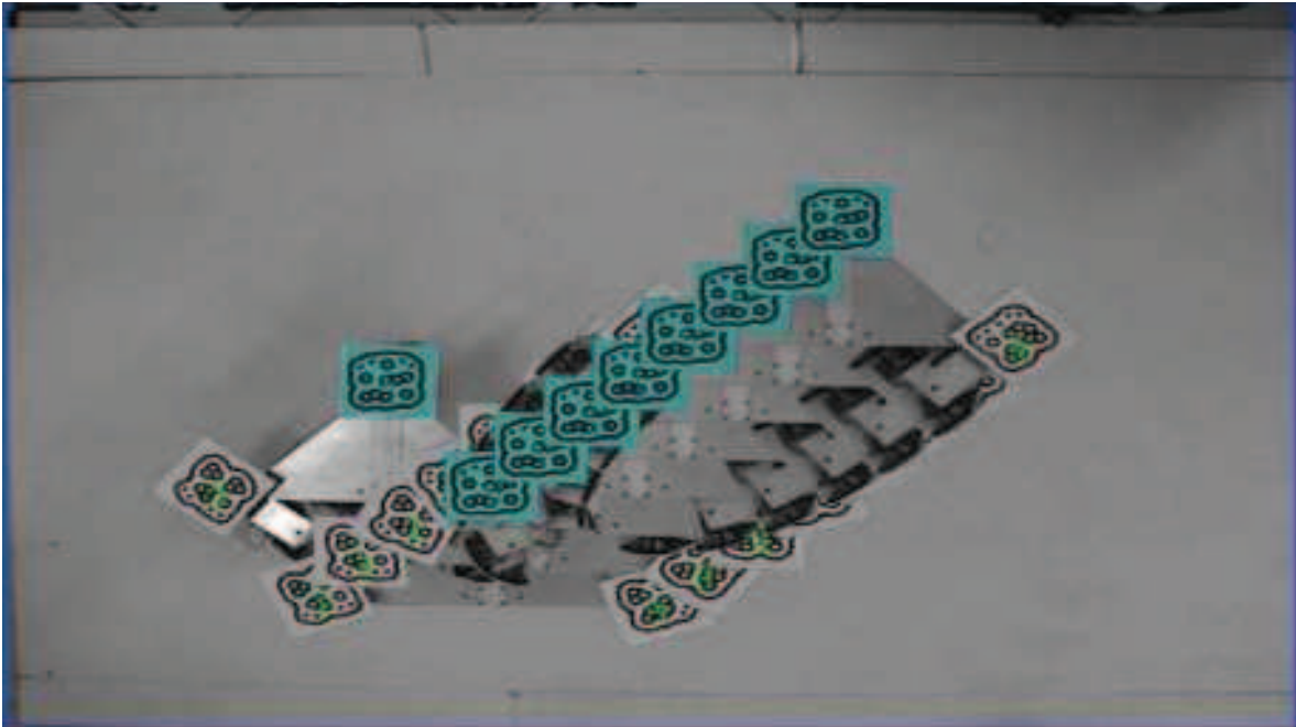
Figura VI – 24 Prueba de seguimiento de trayectoria rectilínea con orientación fija en lazo cerrado.
