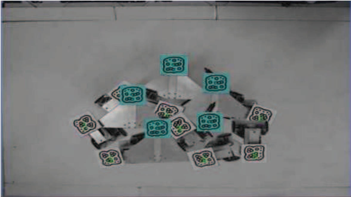
Figura VI - 39 Prueba de trayectoria circular del punto de análisis con orientación fija.
