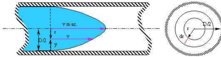
**Fig. 2.9 Corte transversal y axial del flujo en una tubería**
