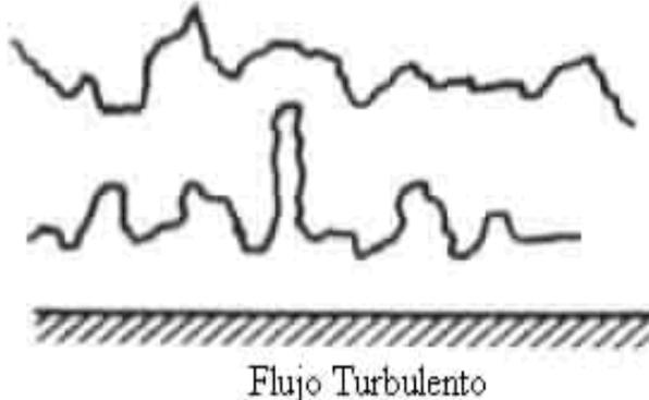
**Fig. 2.2 Comportamiento de las partículas dentro del flujo turbulento**
