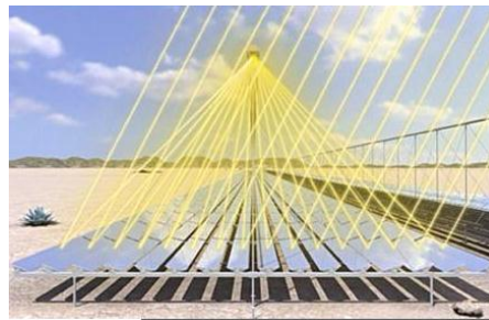
Figura 1. 13 Concentrador FLC en la planta Puerto Errado 1 en Murcia. 15
