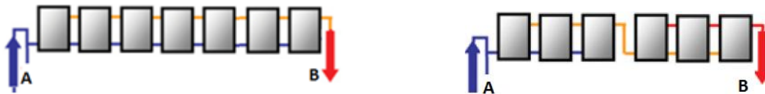
Figura 4. 3 Colectores por ramal, izq.) Paralelo, der.) Serie-Paralelo
