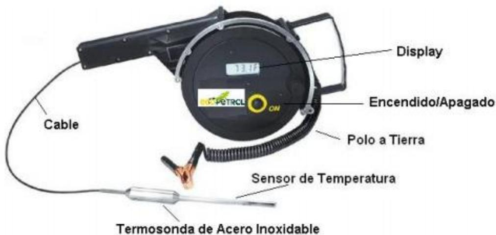
**Figura II.59 Termómetro electrónico.**
