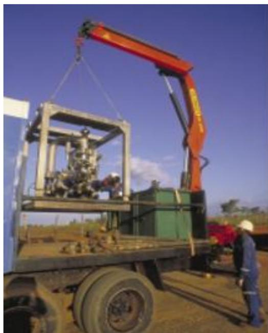
**Figura II.19 Transporte de un medidor Vortex.**
