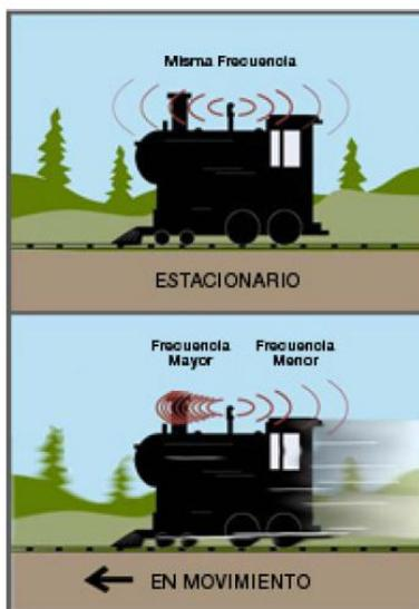
**Figura II.42 Ejemplo ilustrativo del efecto Doppler.**
