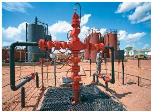
**Figura A.2 Árbol de válvulas conectado a dos líneas de descarga.**
