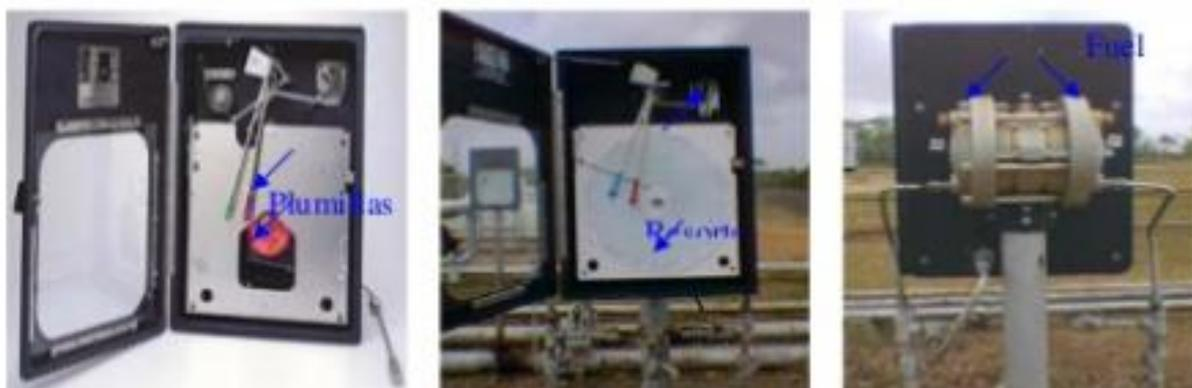
**Figura II.8 Partes externas del registrador mecánico Barton.**
