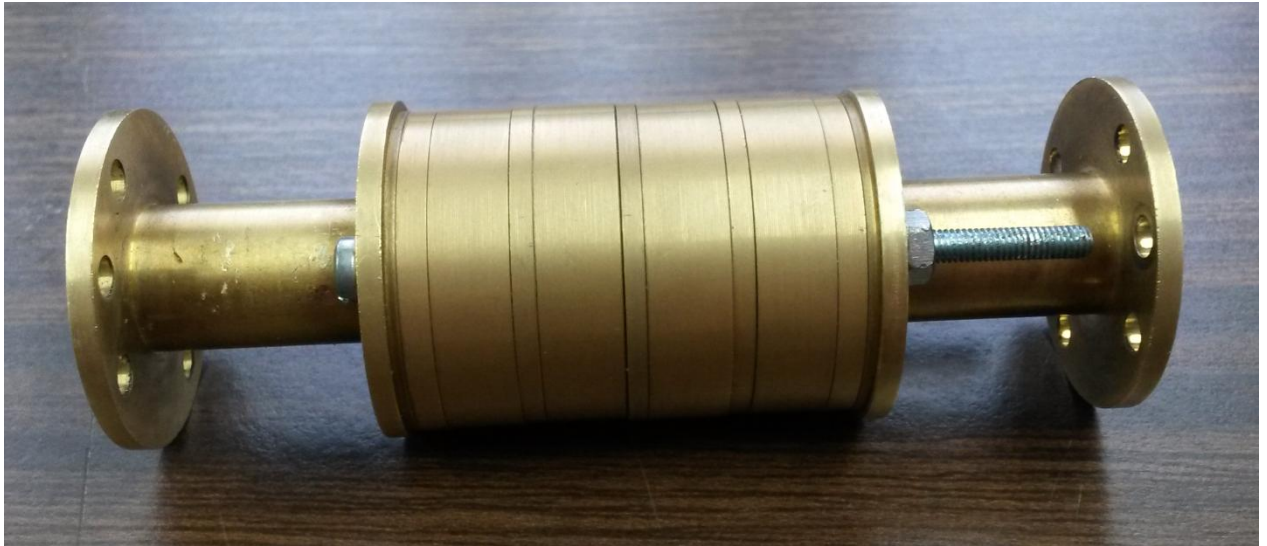
Figura 5.6 Polarizador basado en guía de onda circular con diafragmas elípticos armado.
