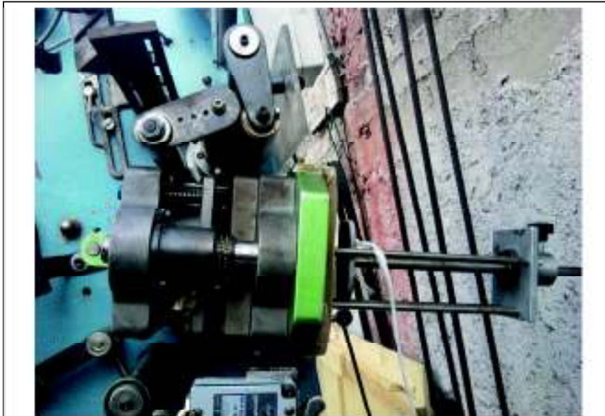
Fig. 1.15 Troquel de la suajadora. Asimismo, se puede observar la barra de guía para el almacenamiento de las tapas cortadas.
