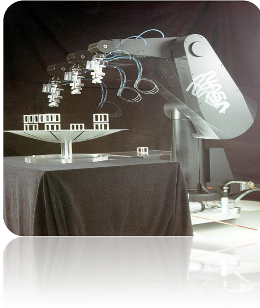
Figura 1.8 Robot “PUMA” de la empresa Unimation, utilizado ampliamente en el ensamblaje de autos en la década de los 80.
