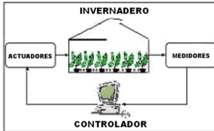
Fig.37.- Sistema de control retroalimentado en un invernadero.
