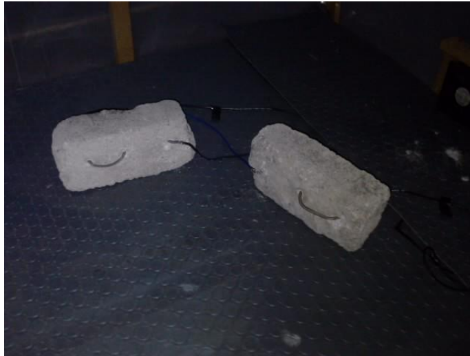
Fig.79.-Calefaccion mediante resistencias eléctricas.
