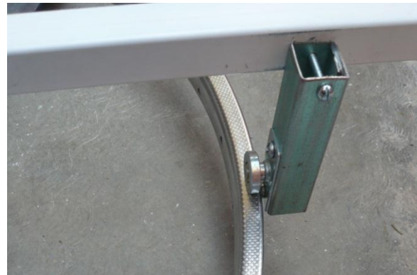
Figura 63: Riel y llanta montada (acercamiento)
