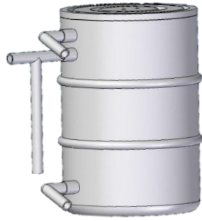
Figura 52: Termotanque con conexiones
