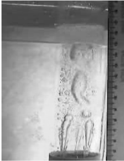
Figura 6-14: Fotografía de la dinámica de las burbujas generadas en conos de \alpha = 75^\pm , donde se puede ver que las burbujas coalescen en el centro de la columna y forma una burbuja grande, pero que no levanta lo suficiente a la superficie libre del líquido como para tener producción.
