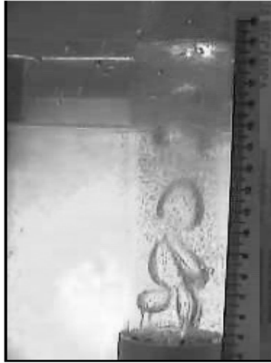
Figura 6-13: Fotografía que muestra como se genera el burbujeo de las tres agujas de inyección en la base de la bomba "Panal de abeja". Las burbujas coalescen en la proximidad de las agujas de inyección formando una burbuja compuesta que sube rápidamente por las fuerzas de rotación, empujando la columna de líquido hacia la línea de producción.
