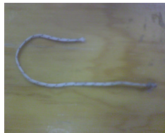
Figura 5.1 Cuerda utilizada para mover alerones de avión.
