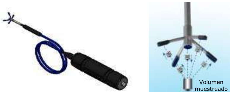
Figura III-11 Vectrino (izquierda) y su funcionamiento (derecha)
