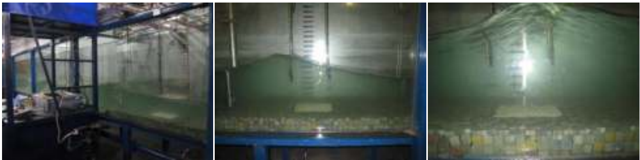
Figura III-15 Pruebas de inicio de arrastre
