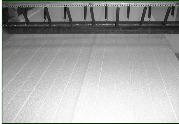
Figura 3.5 Corte de un bloque de EPS
