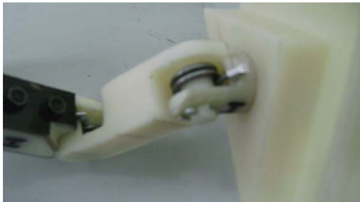
Figura 4.23. Terminales de resortes torsionales muy cortas.
