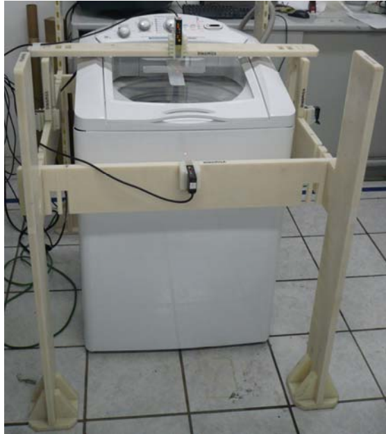
Figura 2.43. Arreglo sensores para medición de vibración en gabinete.
