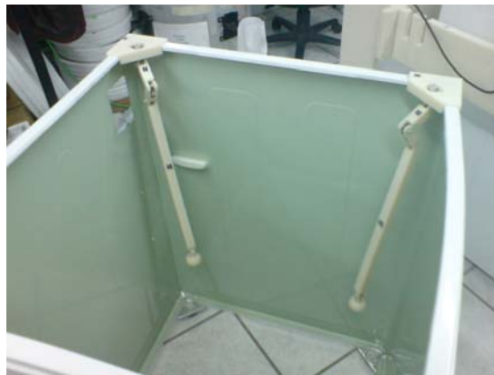
Figura 4.15. Ensamble de suspensión prototipo en gabinete de producción.
