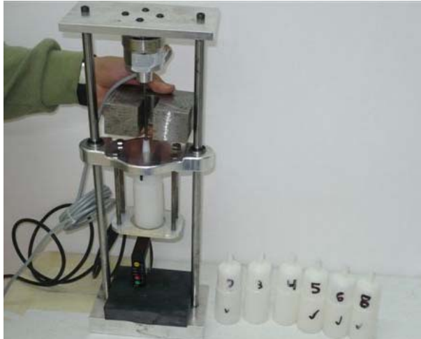
Figura 3.33. Dispositivo de medición de amortiguamiento por fricción.
