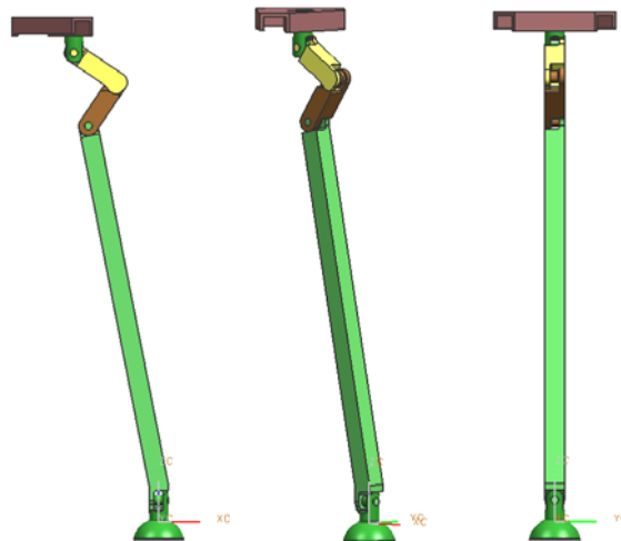
Figura 4.2. Concepto de suspensión de eslabones y articulaciones rotacionales.
