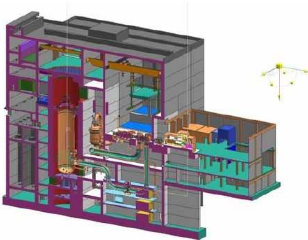
Figura 1.4. Sección transversal del edificio del reactor
