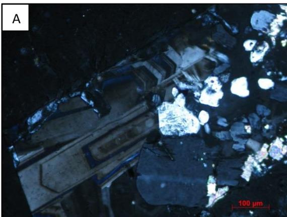
En la figura A se muestra un cristal Euedral de granate con alto contenido en Itrio, esto significa que creció al mismo tiempo que el granate y bajo condiciones estables.
