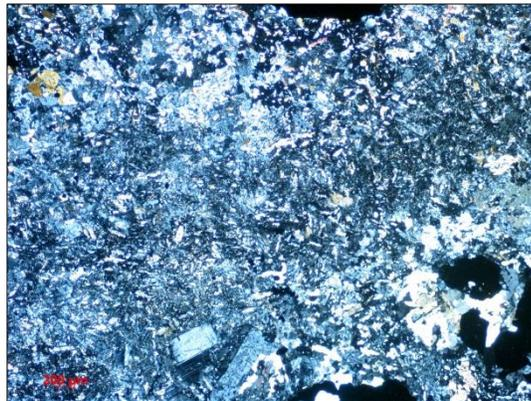
Fig. 26 Muestra XA-48 piroxenos rodeando a plagioclasas y a cristales de sulfuros.
