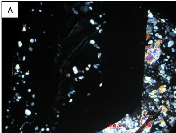
En la fotografía A se puede observar un granate con textura poiquiloblástica con bandas de granate isotrópico y bandas de granate anisotrópico, este granate presenta bandas de crecimiento oblicuas a las bandas de granate isotrópico que nos indica que se formaron en un proceso anterior a la formación de la banda donde se encuentran alojadas. Las inclusiones que se observan (zonas blancas) son cristales de cuarzo.
