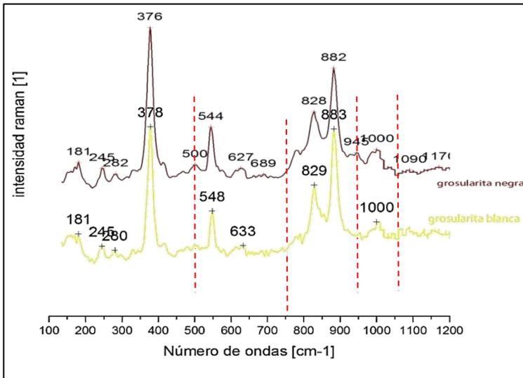
Fig. 55 Graficas de espectro Raman para bandas de granate en color blanco y negro donde se muestran los cambios de ancho de bandas registradas, estos cambios se encuentran señalados por las líneas punteadas en rojo.
