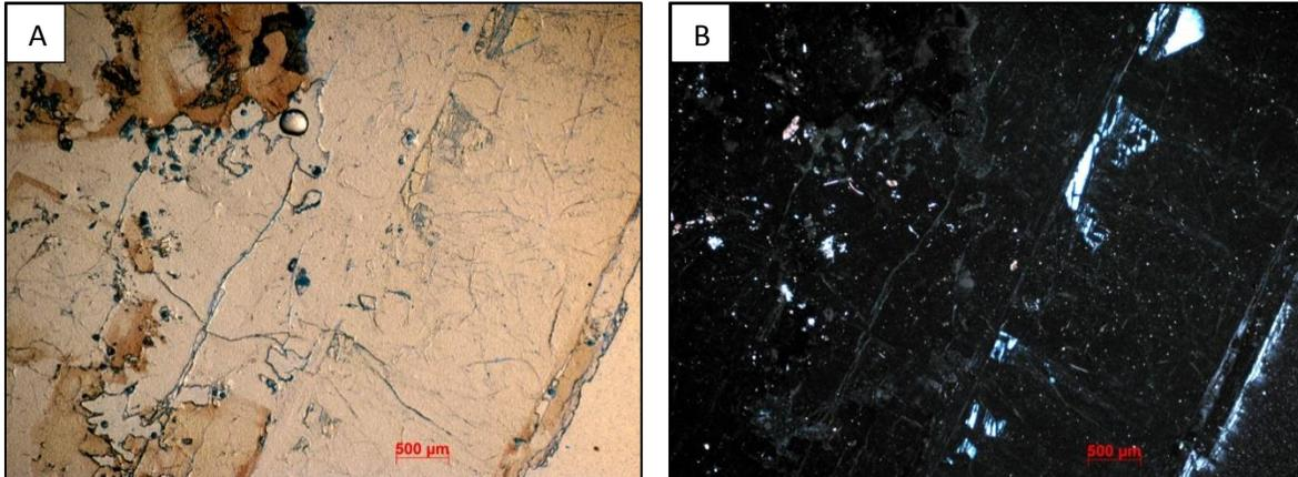
Figura A sección delgada con luz transmitida donde se observa una coloración parda clara en el granate y bandas de crecimiento, en la figura B se observa la misma área en nicols cruzados se aprecian las inclusiones orientadas a las bandas de crecimiento, se observa que en las zonas pardas de la figura A el número de inclusiones es menor.
