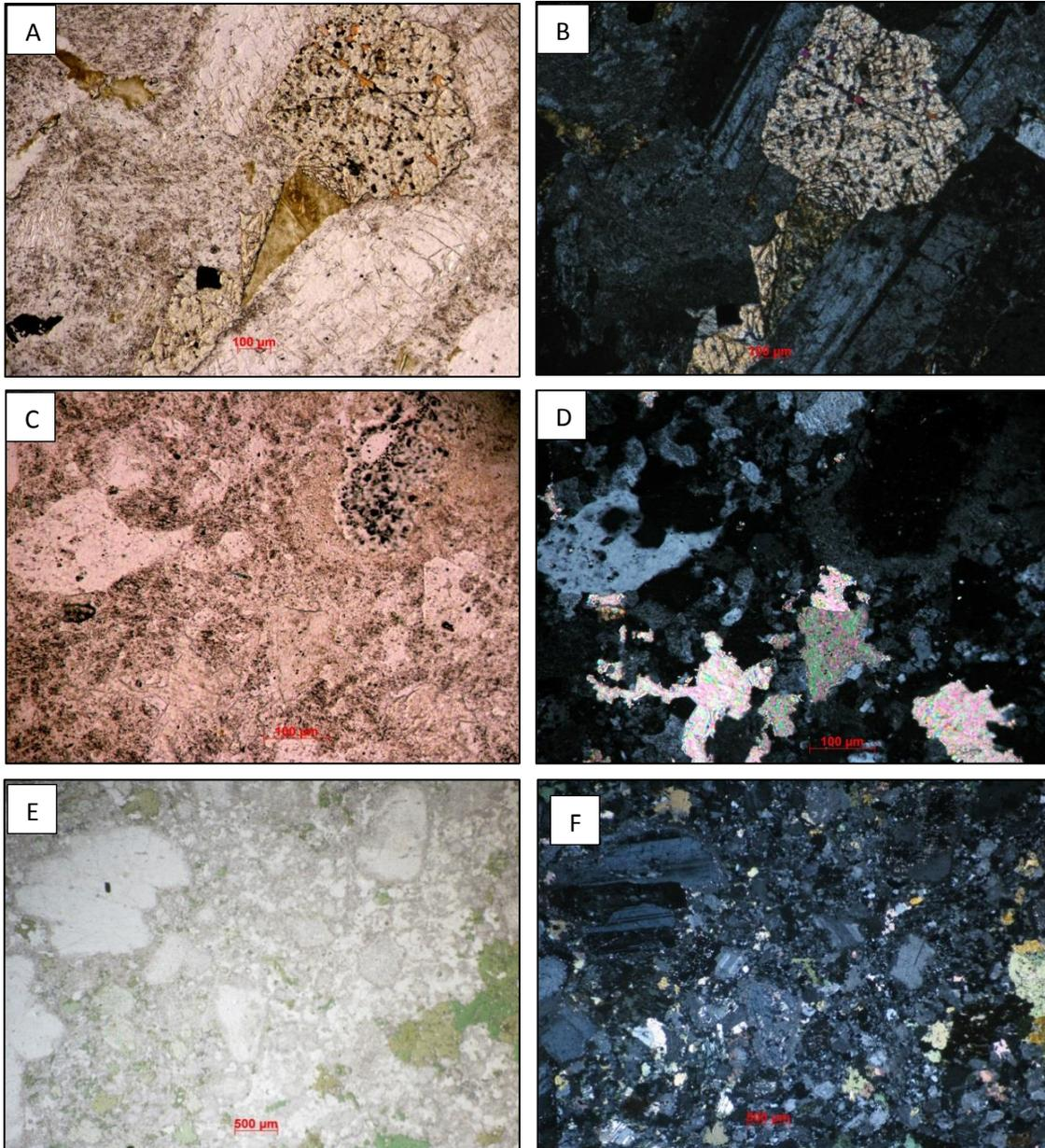
A y B fotografías de la diorita (XA-1) se puede observar plagioclasas, hornblenda, piroxenos y piritita; C y D pórfido diorítico XA-20 se puede observar feldespato, cuarzo, titanita, calcita y rutilo además de arcillas producto de la alteración de feldespatos; E y F muestra XA-22 plagioclasas y cuarzo con aglomeraciones de diopsido rodeados de clorita.
