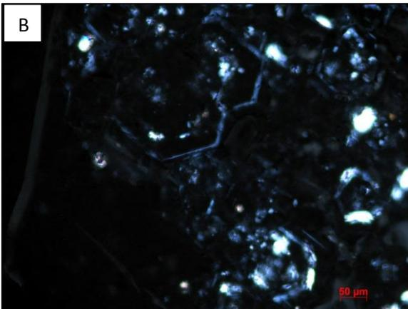
La fotografía B muestra el sobre crecimiento de granates, presentan un núcleo con textura poiquiloblástica mientras en la parte exterior del cristal desaparece esta textura y en su lugar aparecen bandas de crecimiento de granate isotrópico y en la parte exterior del cristal bandas de granate anisotrópico.
