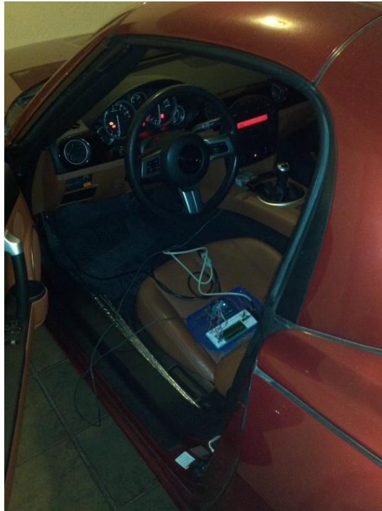
(Figura 3.9 – Fotografía de primeras pruebas del circuito con pantalla LCD)
