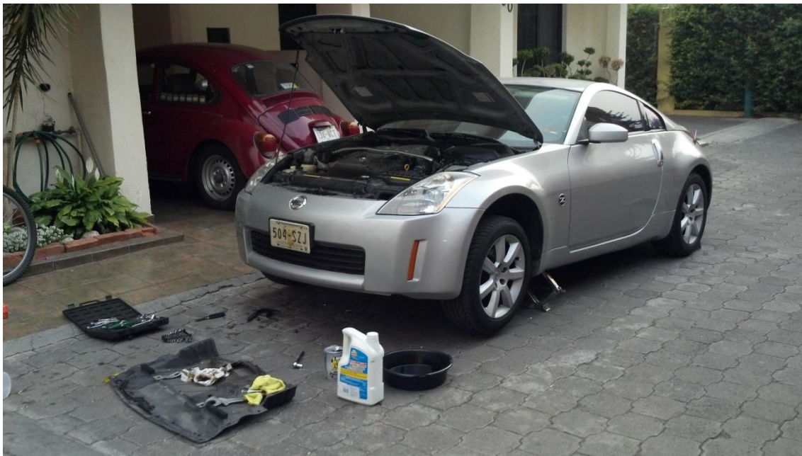
(Imagen 4.2 – Drenado de aceite de Nissan 350Z para provocar DTC P0524)
